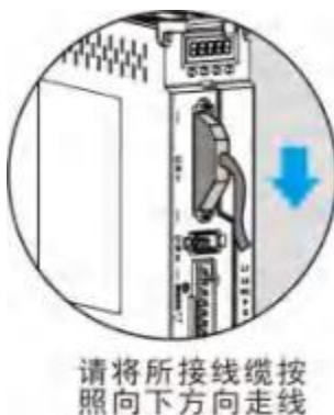
图 1.2 伺服驱动器线缆走线要求示意图
